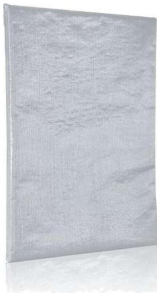
I pannelli vengono privati dell'aria al loro interno fino a ottenere bassissime pressioni: tale processo riduce fortemente la mobilità delle poche molecole d'aria rimaste, diminuendo la conducibilità termica, che raggiunge valori addirittura **inferiori** a 0,002 W/mK.
