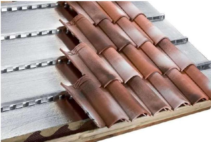
Posare struttura per copertura microventilata. Questa può essere eseguita con morali in legno o in metallo, solitamente posati ad interasse di 50/60 cm . Sotto ai morali posare il feltro nanotecnologico NANOFELT
