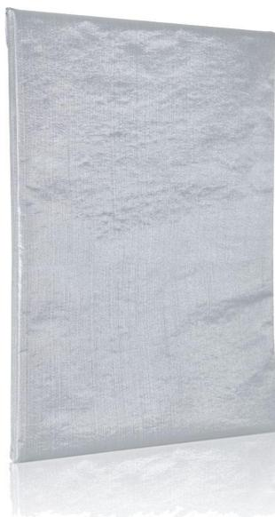
Los paneles son privados del aire de su interior hasta obtener presiones muy bajas: este proceso reduce enormemente la movilidad de las pocas moléculas de aire restantes, disminuyendo la conductividad térmica, que alcanza valores incluso inferiores a 0,002 W/mK.
