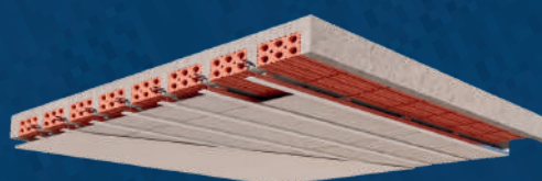
CIELO RASO EN ADHERENCIA
