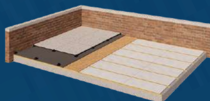
SOTTO PANNELLO OSB O FIBROCEMENTO
